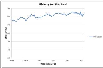
FIGURE 2.3 EFFICIENCY OF ANTENNA AT 2.4/5GHZ BAND IN FREE SPACE
