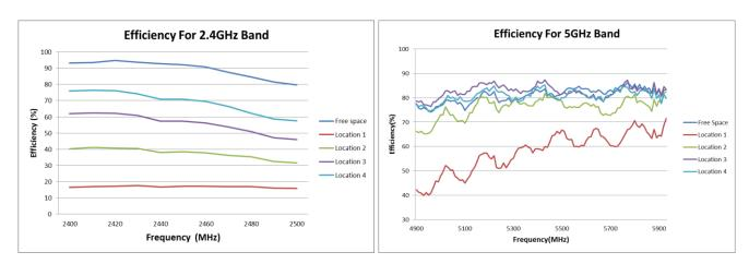
FIGURE 4.2.2 EFFICIENCY OF ANTENNA AT 2.4/5GHZ BAND AT FOUR LOCATIONS WITH PARALLEL GROUND
